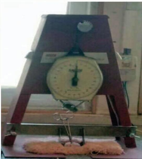
يجرى هذا الاختبار طبقاً للمواصفة القياسية المصرية رقم ٢٠٠٥/١٤٧٧ وطبقاً للمواصفة المنتج حيث يغطى قوة سحب خيوط الوبرة في جميع انواع السجاد (سجاد ذو وبره مقطوعه أو سجاد ذو وبره غير مقطوعه) ويتم إجراء هذا الاختبار في جو قياسي طبقاً للمواصفة حيث تكون درجة حرارة المعمل ٢٠ درجة مئوية ودرجة رطوبة نسبيه  $65 \pm 4\%$
